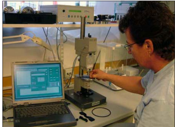
Ann-Cathrine mäter hårdhet med Bareiss digitala universalhårdhetsmätare och vårt dataprogram
