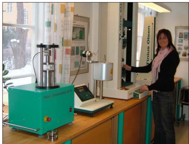
Jenny använder Tinius Olsens 10 kN dragprovare
