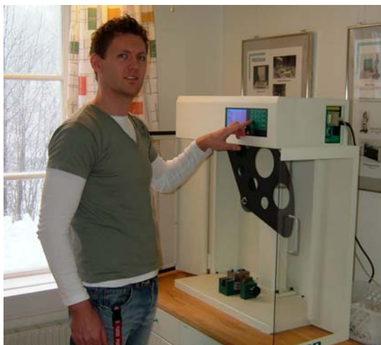
Andreas provar Tinius Olsens nya pendelslagprovare
