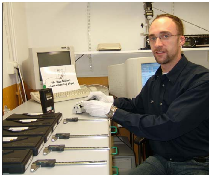
Jonas kalibrerar skjutmått med hjälp av en passbitsstege
