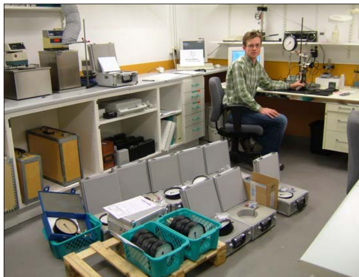
Niklas har fått in ett större antal manometrar från bilverkstäder för kalibrering. Bilverkstäderna använder manometrarna för kontroll av trycket i AC-system
