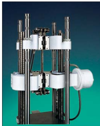
Tvårbalk med öppning för enkelt byte av provkroppar
