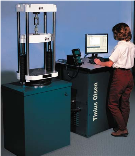
Hydraulisk kompakt drag- och tryckprovare upp till 3 000 kN
