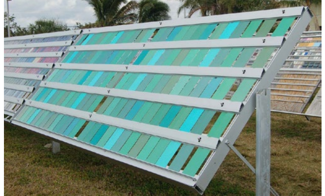
Q-Labs anläggning för utomhusprovning i subtropiskt klimat i Florida.
