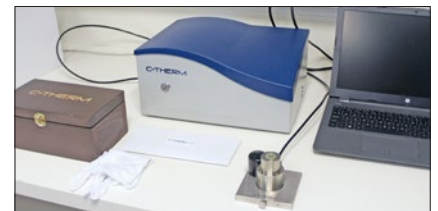
Överst TGA 4000 och DSC 4000, som båda är termooalysinstrument från PerkinElmer. Undre bilden visar TCi från C-Therm, en termisk konduktivitetmätare.
