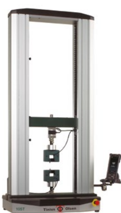
Tinius Olsens nya dragprovare 10ST med 10 kN kapacitet.
