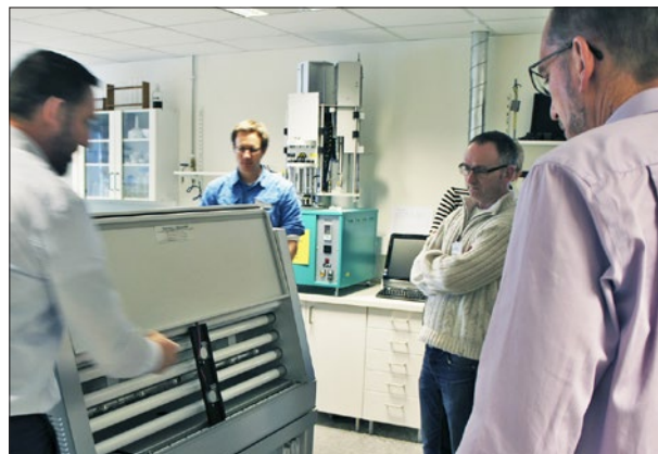
Jim Regan från Q-Lab demonstrerar ett QUV-skåp vid en workshop under ett seminarium om väderprovning.
