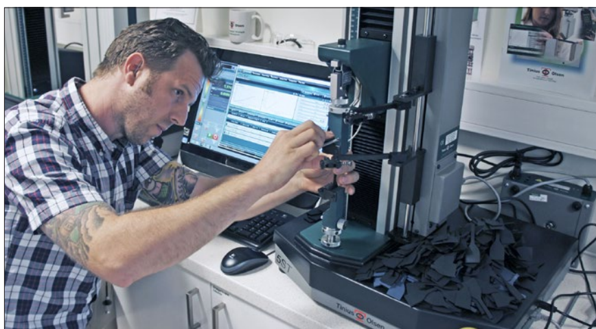
Filip Säfsten på Fogutek var också en av gummiutbildningens kursdeltagare. Här utför Filip dragprovning i Elastocons provningslaboratorium, som en del av sitt examensarbete. Han använder en 5 kN dragprovare från Tinius Olsen. Fogutek köpte under hösten denna modell av dragprovare samt en reometer från Montech – MDR 3000 Basic.
