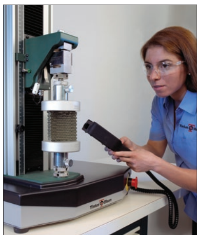
Bilden visar en dragprovare i ST-serien i enpelar-modell med kapacitet upp till 5 kN (5ST).
