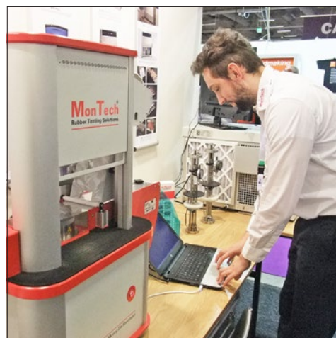
Yann Speyer från MonTech med en vulkreometer i basutförande, för repetitiv kvalitetskontroll och enklare tillämpningar inom forskning och utveckling.
