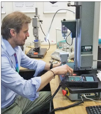
Tinius Olsens områdesansvarige Kostas Fotiadis förbereder en dragprovare för visning. Till höger modell 10ST med kapacitet upp till 10 kN.
